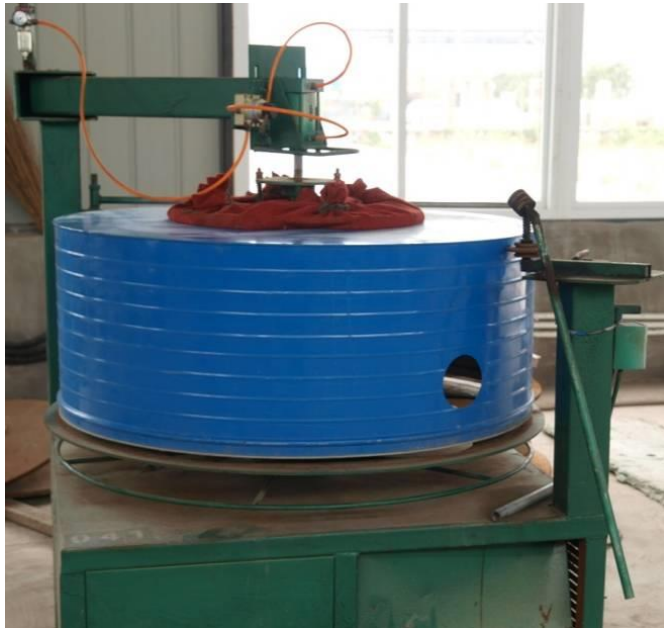
仓底生产 production of silo bottom
