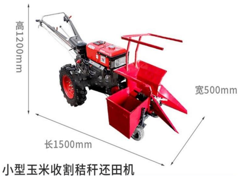
机器重量:120KG 工作速度:2000-3000(M/H)
