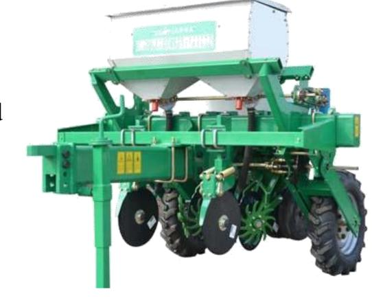
玉米免耕机,由开沟器直接开沟,种药同步播种,省去耕地、施肥等流程。
