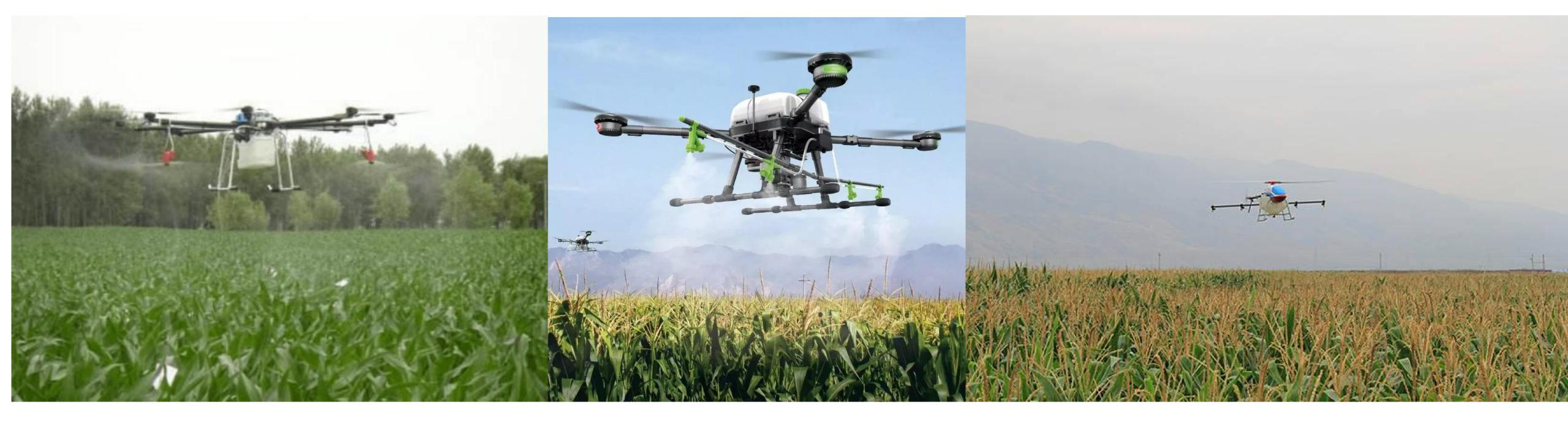
整机重量轻、待电时间长; 机臂可折叠。技术参数:作业速度快(≥7m/s),药箱容积16L,喷雾量: 1600-2000ml/min;
