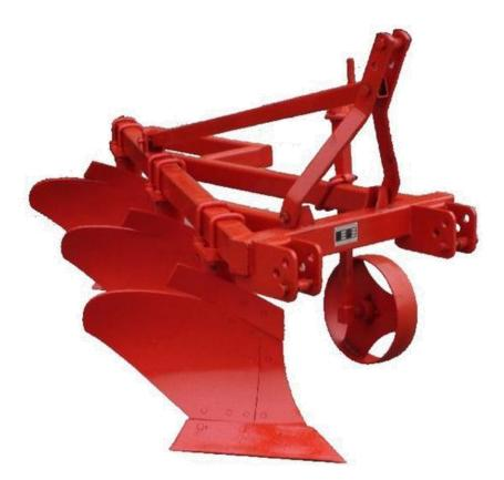
铧式犁主要适用于农田耕地灭茬,破除地表板结,秸秆切碎还田,耕后碎土。铧式犁作业效率高,入土碎土能力强,耙后地表平整,对粘重土地、荒地和杂草多的地方具有很强的通用性。主要有一下两个特点:
