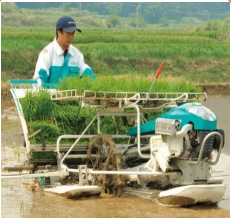
久保田手扶2ZS-4B式 插秧机 Kubota Handheld 2ZS-4B Rice Transplanter
