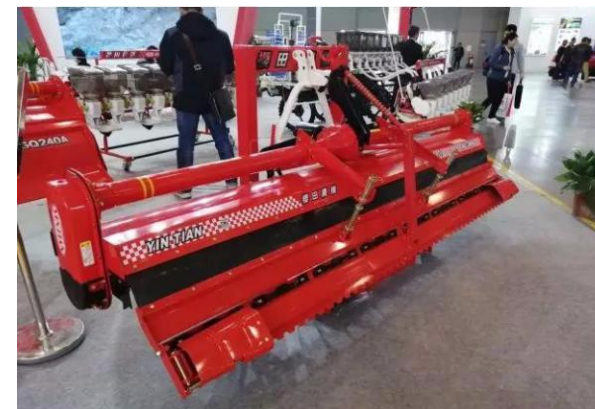
樱田1GSZ-280水田埋茬耕整机 Yingtian 1GSZ-280 paddy field stubble tiller
